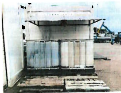
Zapasowe 2 zbiorniki o pojemności. 1m 3 na wody zaolejone
